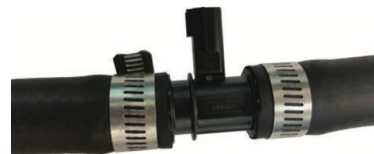
Abbildung 8: Derartige Durchflusstemperaturesensoren werden zur Regelung der Kühlmitteltemperatur in Batteriemanagementsystemen eingesetzt
